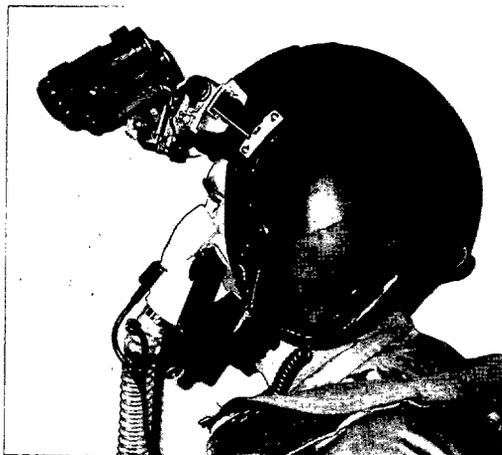
Las gafas en posición de reposo; se puede apreciar el soporte que las mantiene unidas al casco.
