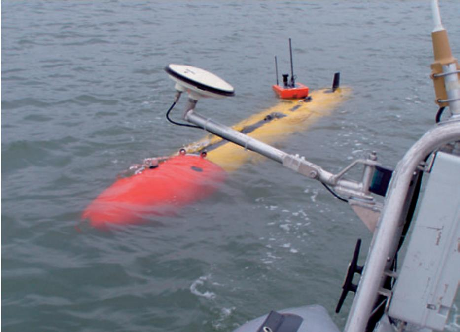
Figura 2: vehículo autónomo submarino *Ocean Explorer* del NURC.
