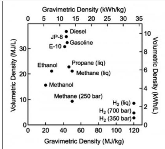
Comparación de la energía por unidad de masa y por unidad de volumen de varios combustibles en base a su poder calorífico inferior
