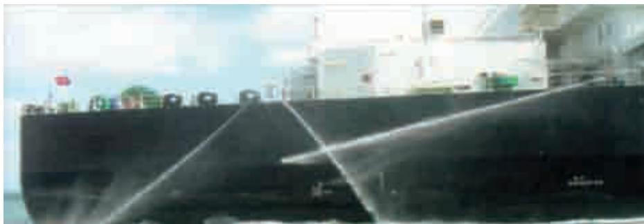
de una lancha que intenta abordar el buque. Se implementan en plumas de 10 metros a ambos lados del casco, creando un área no transitable para los piratas.
