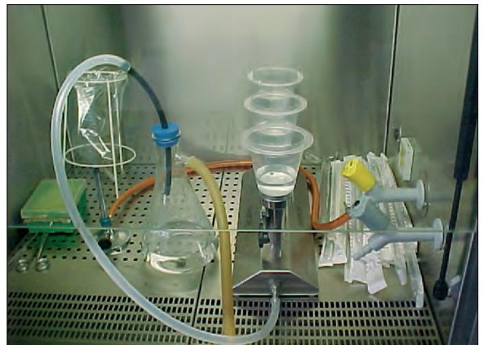
Fig. 1. Rampa de filtración por vacío.
