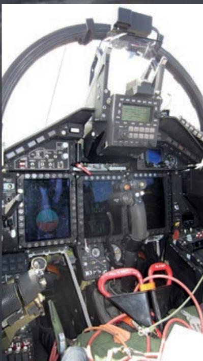
Cabina del MiG-29OVT utilizado para evaluación en vuelo, con configuración muy similar a la del MiG-35; nótese que en este, las etiquetas de los pulsadores e interruptores tienen etiquetas en inglés. (Imagen: Vitaly V. Kuzmin)
