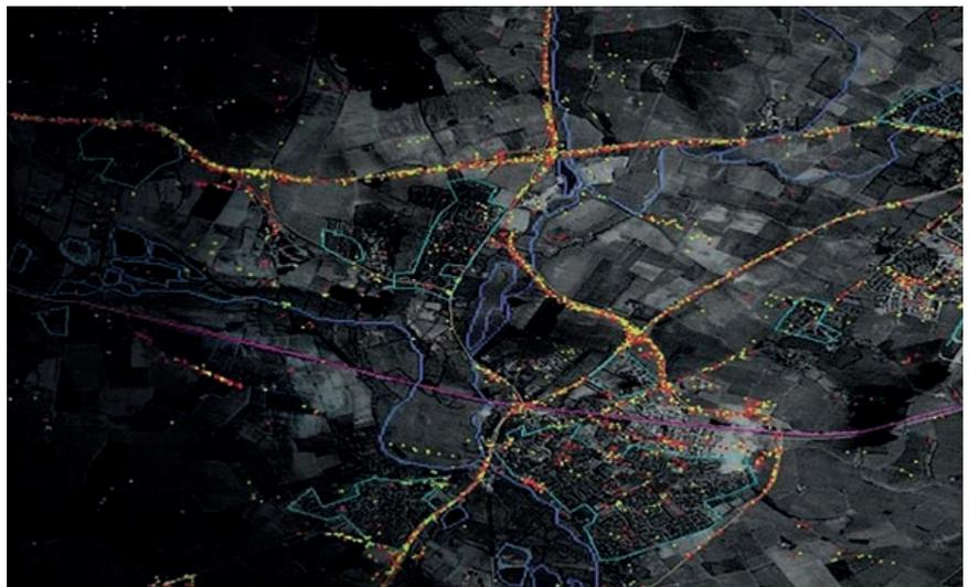
Imagen GMTI obtenida de la observación de una ciudad. Los colores pueden ser definidos por el operador, por ejemplo como indicadores de velocidad
