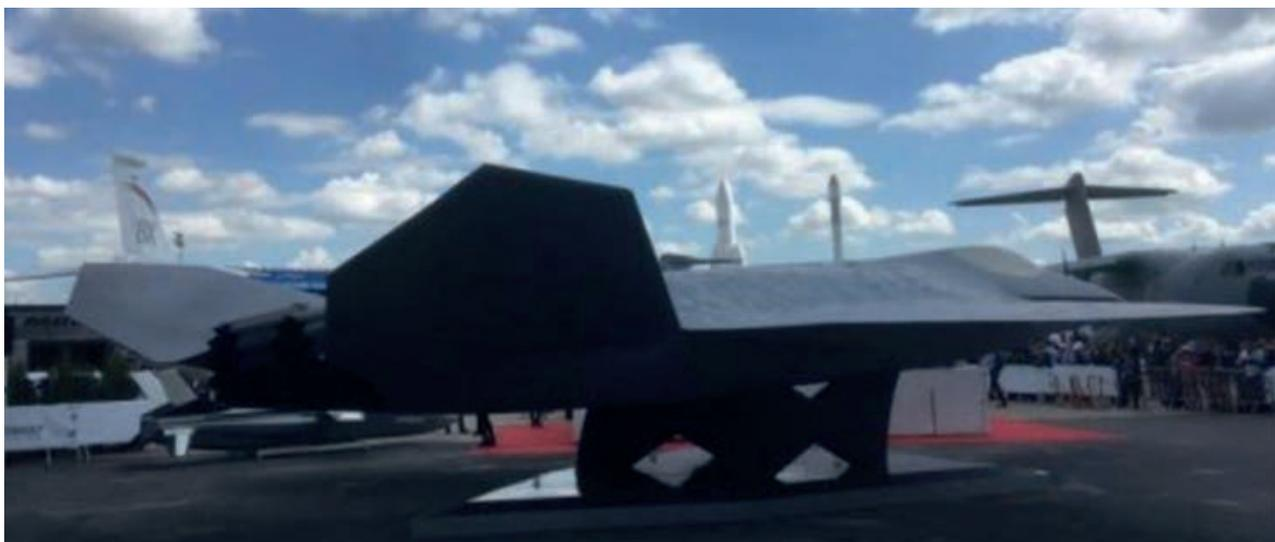
Vista lateral-trasera del NGF. Se puede apreciar la generosa superficie de las superficies aerodinámicas -fins- y la morfología de los nozzles
