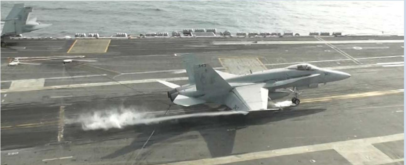
*Hornet 343. Enganche del tercer cable, foto tomada desde la plataforma del portaaviones.*
