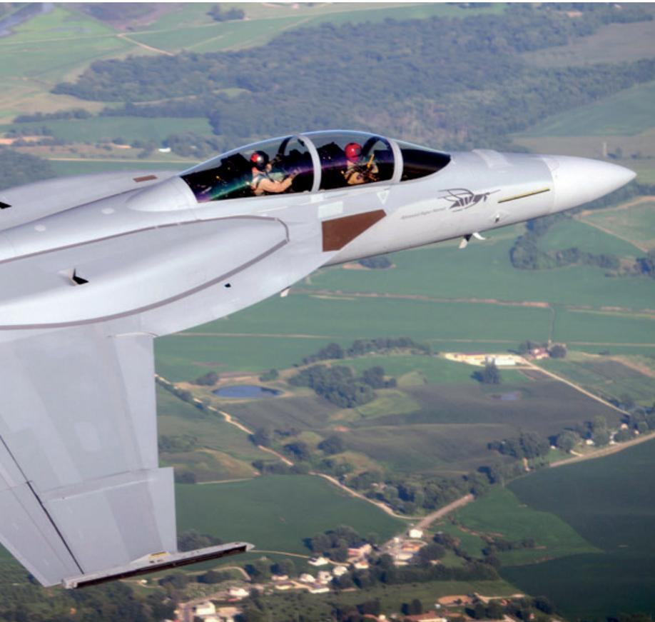
campo de visión como ocurre actualmente. Siempre según Boeing, la resistencia aerodinámica con los CFTs no sólo no se ve penalizada, sino que además se ve disminuida entre Mach 0.6 y Mach 0.8, aumentando ligeramente en régimen supersónico.
