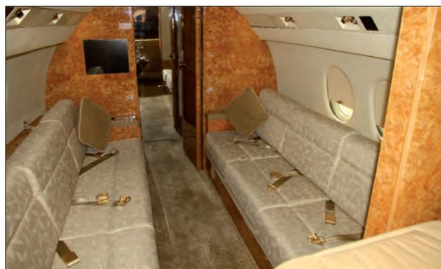
*Los dos módulos de la cabina de pasaje del Falcon 900, el delantero –VIP– (izda.) y el trasero para el séquito (dcha). Foto: Julio Maíz.*
