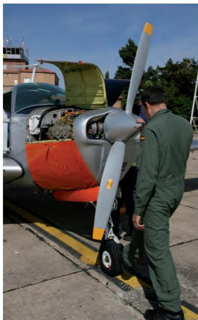
**Un piloto del 42 Grupo realizando la pre vuelo de su Bonanza. Destacar que este material aéreo del Ejército del Aire utiliza todavía un motor de explosión, en concreto un Continental de 6 cilindros.**
