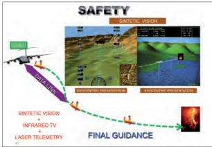
El elemento principal a emplear son los DPA, lanzados a media cota, por la rampa trasera de la bodega de carga de aviones de transporte pesado, como pueden ser los C-130 Hércules, AN-12, Kc-390, A-400M, IL-76, C-17 o incluso aviones con mayor capacidad de carga, que actúan como AL. Estos depósitos conteniendo agente extintor, tienen capacidad de planeo y están dotados de un sistema de guiado (satélite, inercial e infrarrojos) para dirigirse de manera autónoma a la zo-
