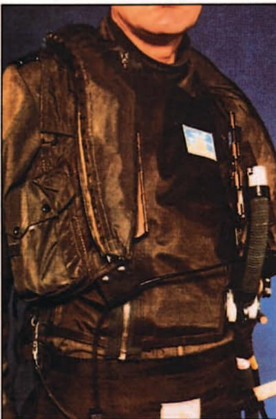
Figuras 3 y 4. El suministro de gas a presión positiva disminuye la fatiga producida por las altas aceleraciones mantenidas, si bien precisa de la utilización del chaleco de contrapresión al que se le inyecta gas a la misma presión que a la máscara. Fotografías tomadas de Prior y Cresswell. 1989.
