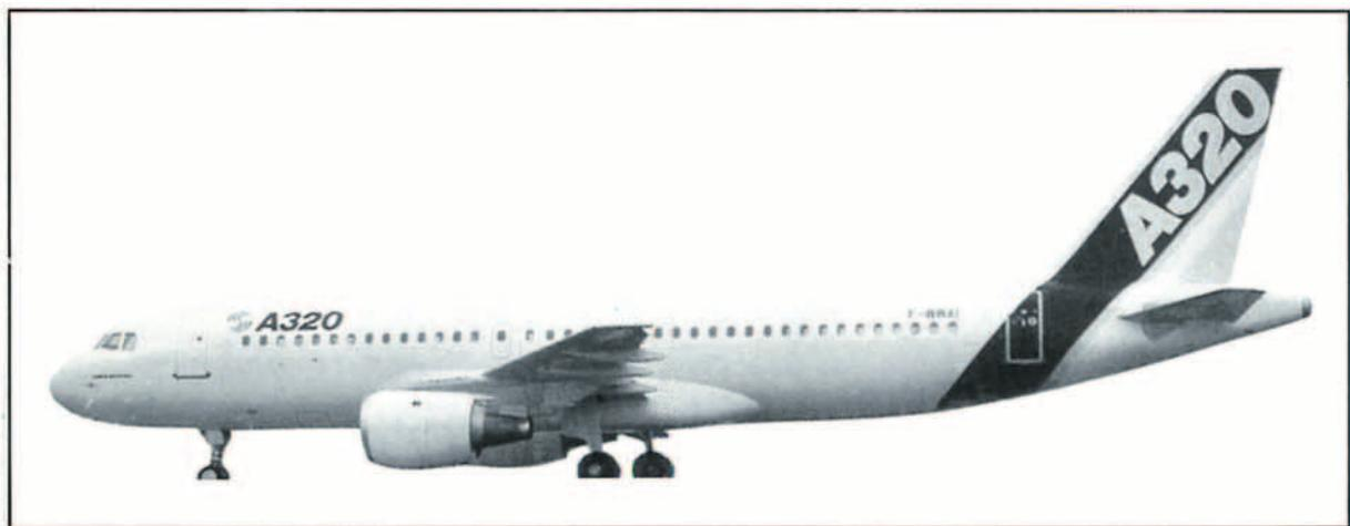
Figura 15b. El Airbus A 320, las series 100 y 200 pueden ser propulsados por los motores CFM 56-5, por el V 2500-A1 y por el V 2500-A2 (utilización para el A 320-100).
