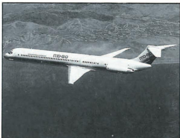
Figura 14. El MD-80, avión básico del cual se han derivado las series 81, 82, 83, 87, 88, e incluye el 90-X, los primeros propulsados por motores PW JT8 de diversos tipos; el 90-X se oferta para ser propulsado por motores CFM 56-5 (figura 10) y V 2500 de IAE (figura 12).
