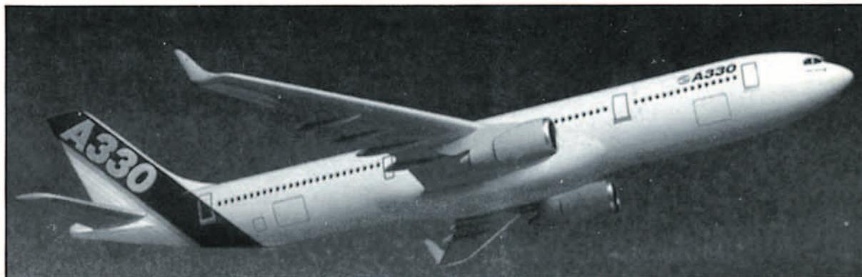
Figura 16a. El avión A 330, con capacidad para 328 pasajeros y un radio de acción de 5.200 MN, estará disponible para el verano de 1993, propulsado por el GE CFG C2 (figura 5), el PW 4000 (figura 11) o el RR-RB 211-700.
