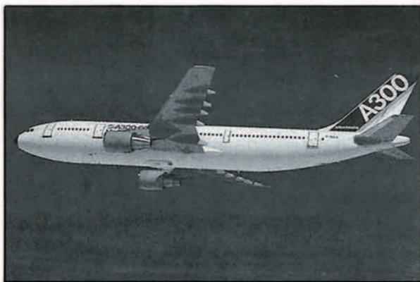
Figura 6. Airbus A 300-600, con un radio de acción superior a 8.000 Km., que se oferta con dos tipos de motores: el GE-CF8-80 C2 (figura 5) y con el PW 4000 (figura 11).
