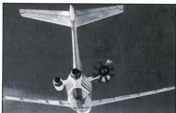
Figura 22B. Vista posterior de un B 727 con un motor UDF en la posición número 3, en pruebas.
