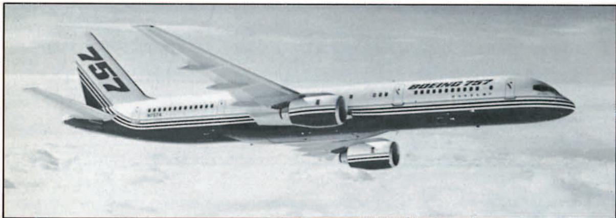
Figura 4. El Boeing 757 se oferta para ser propulsado por el PW 2037 (figura 2) o el RB 211-535-E4 (figura 3).
