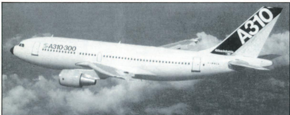
Figura 15a. El avión Airbus A 310, en la serie 200 ó 300 puede ser propulsado por los motores GE-CFG-80 A1/A3/C2 (figura 5), por el PW-JT9D-7R4D1/E1/E3 y el PW-4000 (figura 11).
