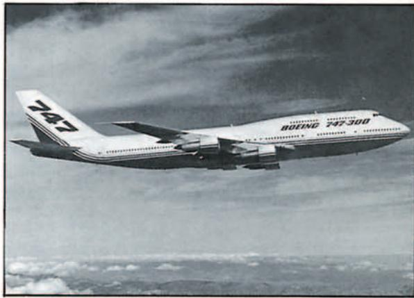
Figura 7. El Boeing 747-300 para 400 pasajeros y 6.300 MN. Se oferta con motores GE-CF8-80 C2 (figura 5) y PW 4000 (figura 11).
