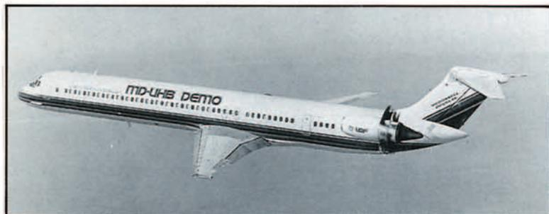
Figura 23A. MD-80, avión demostrador del UDF de General Electric.
