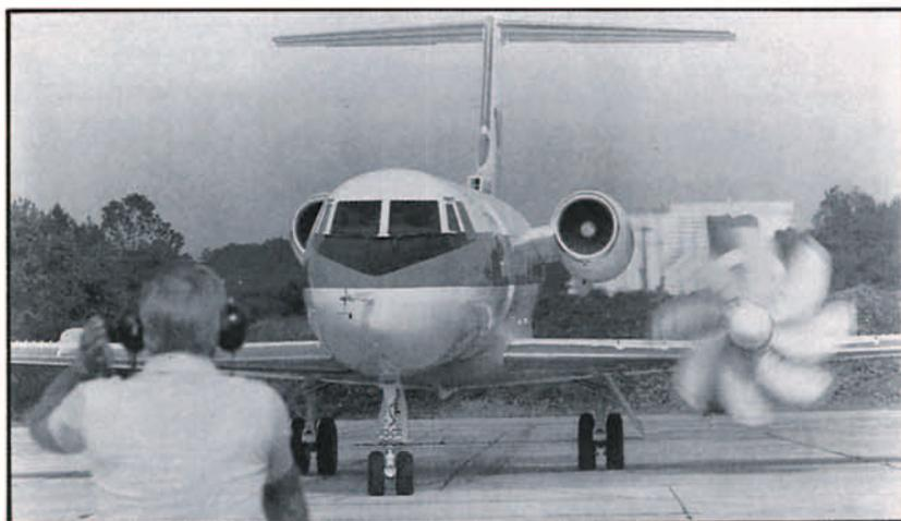
Figura 20. Avión Gulfstream, modificado para pruebas de Propfan (SR) de NASA. Hamilton Std. United Technologies. El motor está montado en el ala izquierda y la dirección del programa de pruebas es de Lockheed-Georgia.
