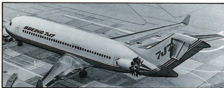
Figura 23B. Visión del nuevo proyecto de avión B 7J7 que será propulsado por el mismo tipo de motor UDF.
