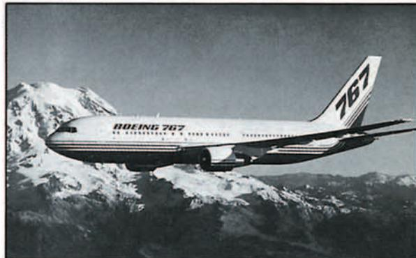
Figura 8. El Boeing 767, se fabrica en dos versiones: el 767-200 para 174 pasajeros y 7.000 MN y el 767-300 con 210 pasajeros y 6.300 MN. Se oferta con motores GE-CF8-80 C2 (figura 5) y PW 4000 (figura 11).
