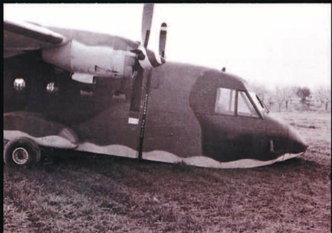
*De izquierda a derecha: Salida de pista por fallo de anemómetro. Sucedió durante el despegue y con el avión repostado y lleno de paracaidistas. No se registró ningún herido. Tan sólo hubo daños materiales (rueda de morro). El comandante de la aeronave era el entonces capitán L. Migallón. Formación en Ala.*
