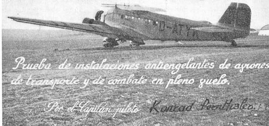
*"Ju-52" utilizado para el estudio de la formación de hielo. Por medio de los tubos colocados detrás del asiento del piloto se envía agua, finamente pulverizada, contra el ala auxiliar, situada encima del fuselaje; de este modo e independientemente de las circunstancias atmosféricas, el ala auxiliar permite una observación exacta del depósito de hielo.*
