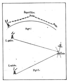
Como a 300 millas los ecos producidos llegarían muy débiles a nosotros, se dotó de un repetidor al avión, que radiaba automáticamente al recibir el impulso, recibiéndose así en la estación el eco reforzado.
