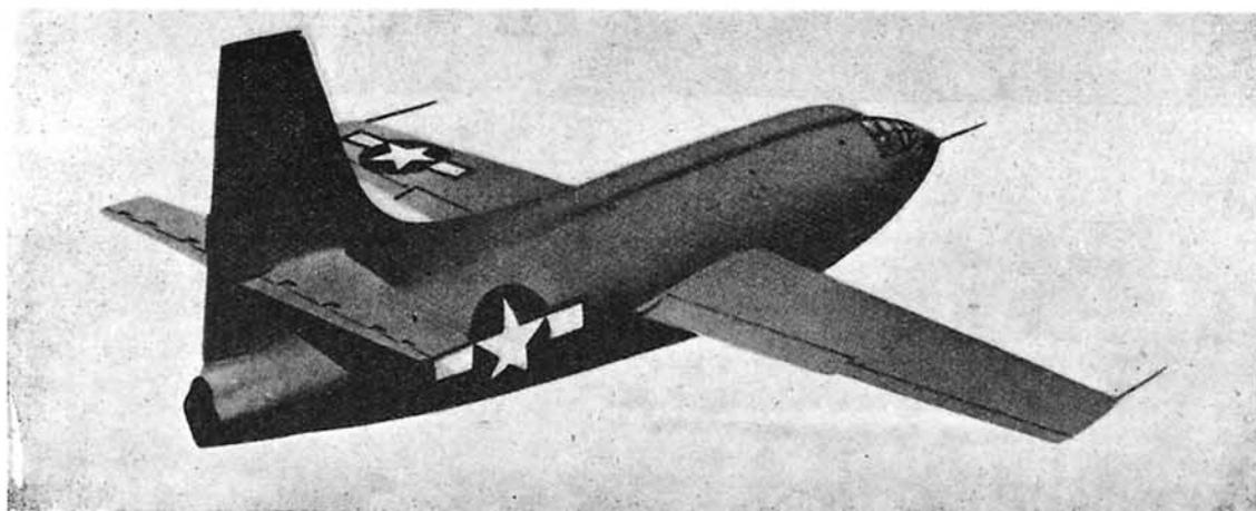
*El "XS-1", en vuelo de pruebas después de ser lanzado por una superfortaleza B-29.*
