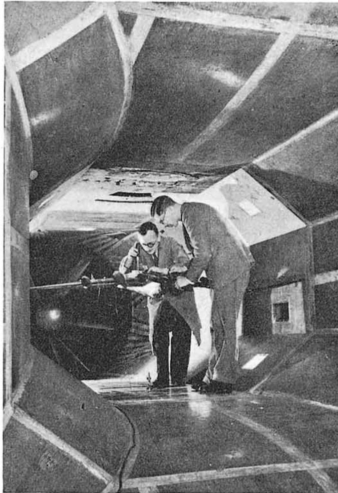
Técnicos especializados colocando la maqueta del avión, que van a probar, en el túnel aerodinámico.
