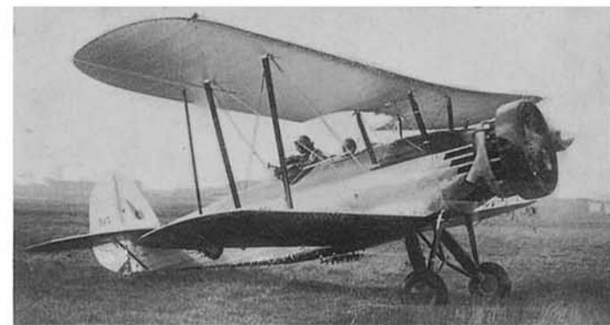
Fig. 5. — Avión *S. V.-5* para entrenamiento, observación y reconocimiento, con motor *Armstrong Siddeley «Serval»*.
