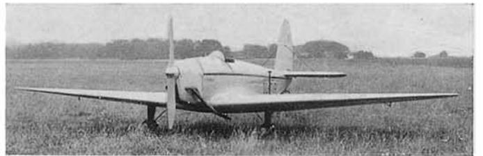
Fig. 14. - Avión *Topsy S.* con motor *Aubier et Dunne* de 540 cc., desarrollando una potencia de 19 cv. Su velocidad máxima con este motor es de 152 kilómetros por hora.
