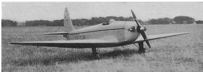
Fig. 13. — Avión *Topsy S.*, con motor *Douglas* de 750 c.c., cuya potencia es de 18 cv. Con este motor desarrolla una velocidad máxima de 150 kilómetros por hora.
