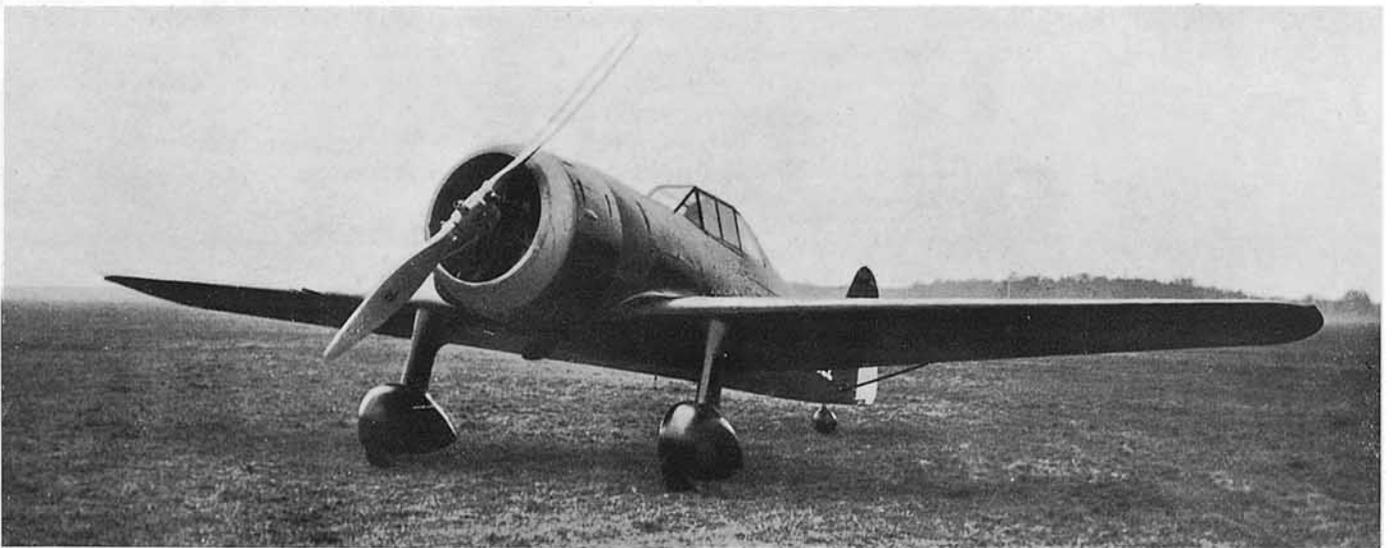
El nuevo avión de caza *Fokker D. 21*, actualmente en período de homologación, que, según sus constructores, ofrece novedades militares originales. Con motor *Bristol «Mercury»*, su velocidad máxima es superior a 400 kilómetros por hora, y con *Hispano-Suiza Ycrs* (motor cañón) desarrolla una velocidad superior a 450 kilómetros.
