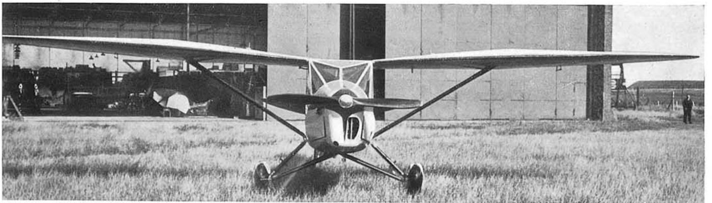
Fig. 11. — Avión *S. 20* para turismo. Triplaza en cabina cerrada. Alas plegables. Motor *Walter «Major»*, de 120 cv.; cuatro cilindros en línea invertidos
