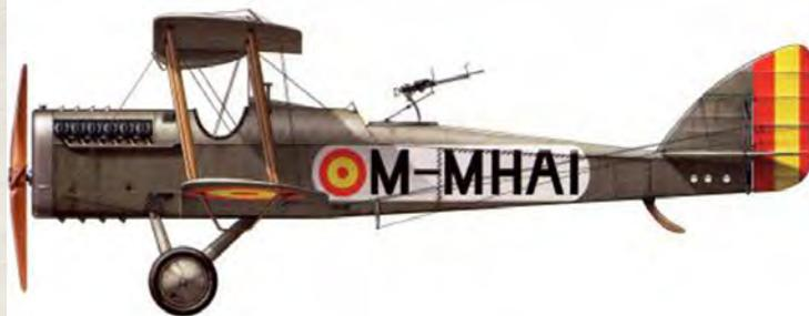
Los De Havilland DH-4, excedentes de la RAF dotados de plantas motrices Rolls-Royce Eagle tenían una envergadura de 12'93 m., una longitud de 9'35 m. y un peso total de 1.083 Kg.
