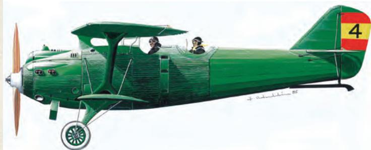
Fue diseñado para sustituir al Breguet XIV. Se presentaba como un biplano de construcción metálica, especialmente sólido, con revestimiento mixto, tela y metal, y de estructura muy simple, fue un bombardero ligero y avión de reconocimiento, construido por la compañía francesa Breguet Aviation a comienzos de los años 1920.
