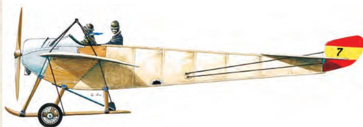
Los Nieuport eran monoplanos, con un peso total de 350 Kg. Su motor un Gnôme rotativo de 80 c.v., que le permitía alcanzar los 110 Km/h. Era un biplaza con los asientos en tandem, en una cabina única tipo bañera y mando en el asiento posterior.
