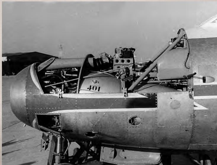
El compartimento motor del 20/1, ya configurado con las dos tomas/tubos de ametralladoras. La foto permite ver, además de los montantes del motor, el revestimiento de la cámara motor, marcada con el 401, y los tabiques de separación de las zonas fría y caliente, así como otros accesorios. La forma de la toma de refrigeración no es aún la definitiva. (Foto: archivo del autor).
