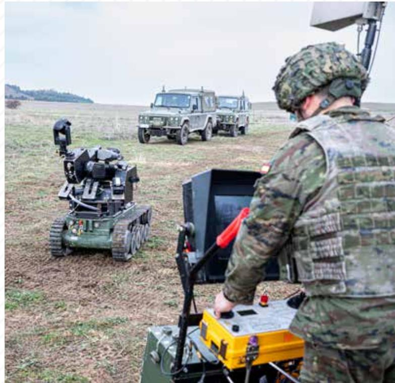
armas de ataque y otros complementos que podemos adaptarle para la desactivación. Es capaz de romper un cristal o una cerradura de una puerta», asevera el brigada Puga, operador EOD en la Sección de Desactivación del Batallón de Zapadores VII.
