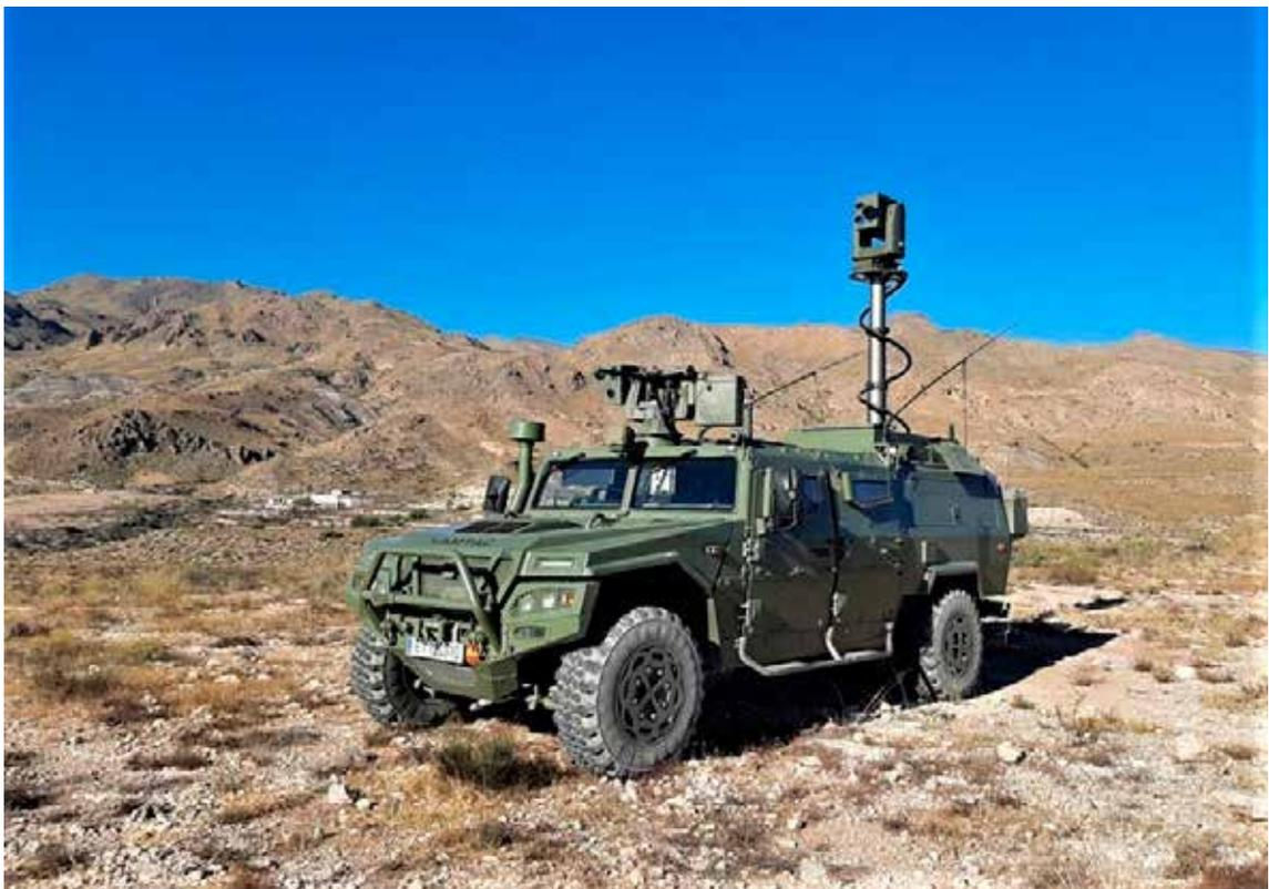
*VERT con el mástil desplegado. Puede diferenciarse en su parte anterior, sobre el parabrisas la estación de armas RCWS «Mini Samson»*
