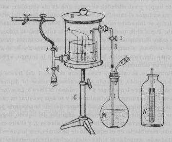
El aparato está constituído por un recipiente cilíndrico A, con dos tubuluras y borde esmerilado de los que se usan para refrigerantes, cubierto con la tapa B, que procede de un desecador al ácido sulfúrico.
