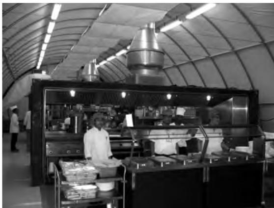
Esta tienda alberga dos contenedores de 20 pies en posición transversal con todos los elementos de calor: 2 marmitas (350 raciones) a presión, 1 sartén basculante, 4 freidoras de 40l, 2 planchas de 90x70, 4 fuegos, 1 horno de 800 plazas, 1 cocedor de vapor, 1 cuadro de elementos técnicos.
