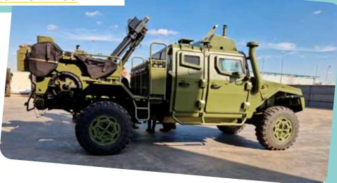
dad del mortero embarcado EIMOS radica en este aspecto, ya que permite realizar un fuego muy preciso desde el vehículo, sin necesidad de estabilizarlo previamente ni dotarlo de nuevos apoyos. El posicionamiento y el cálculo del tiro están completamente automatizados, empleándose el Sistema de Mando y Control TALOS que utilizan las unidades de Artillería de Campaña.
