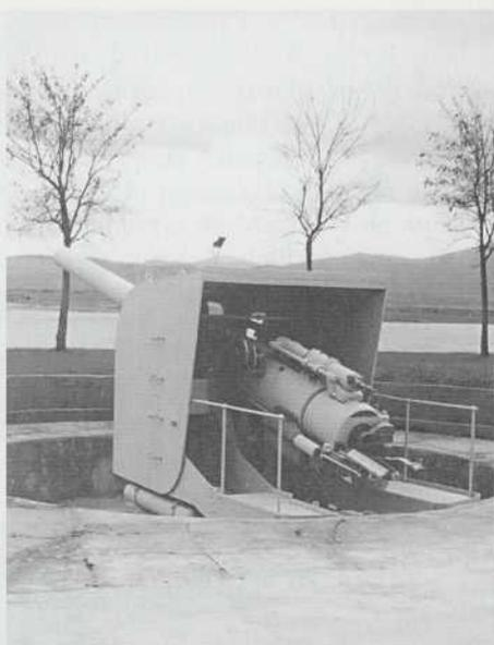
El cañón de costa Vickers de 15,24 cm visto desde la parte trasera. Se puede observar la teja de carga, el cierre y algunos componentes del sistema hidráulico. (Foto: F. J. Álvarez Laita).
