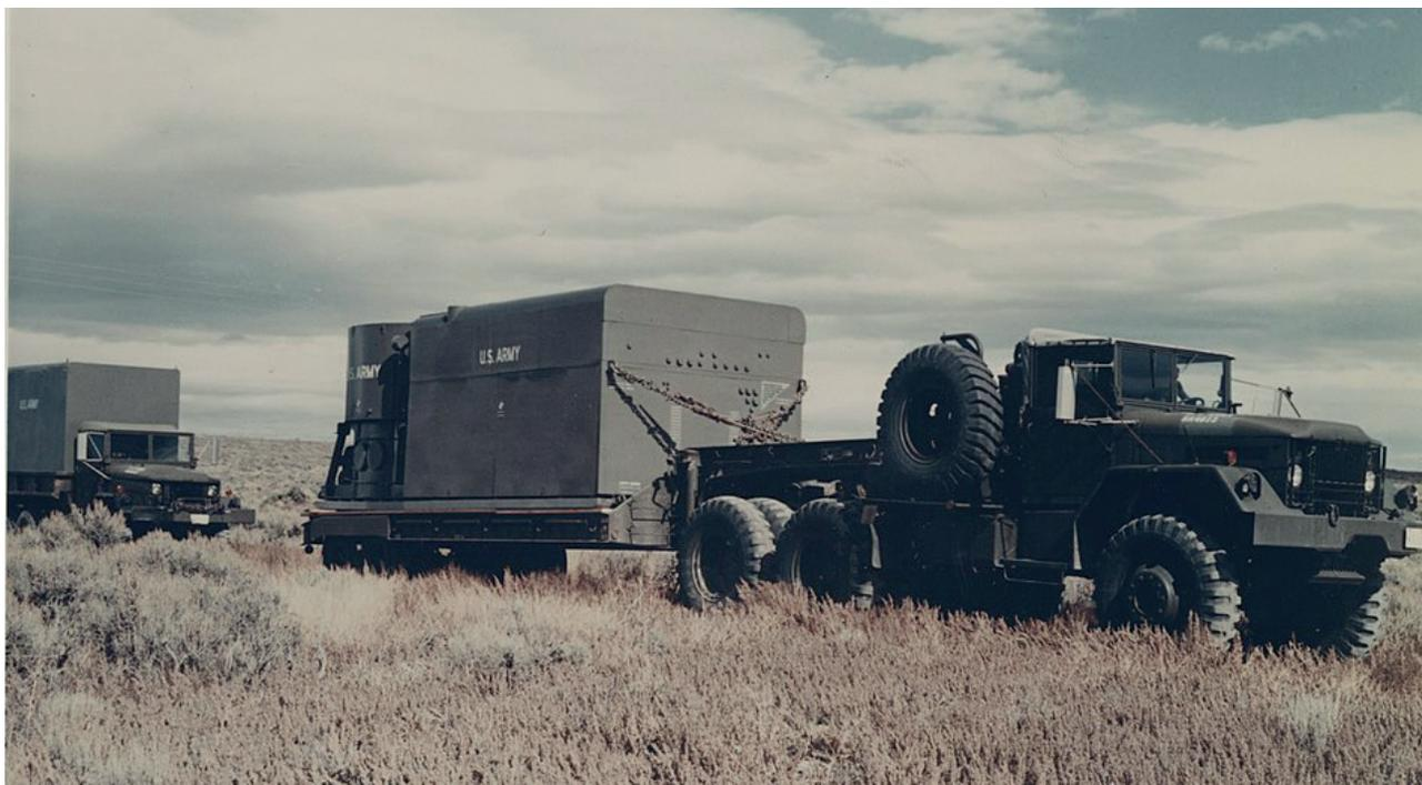
El reactor ML-1 montado sobre un camión en la Estación Nacional de Pruebas de Idaho.
