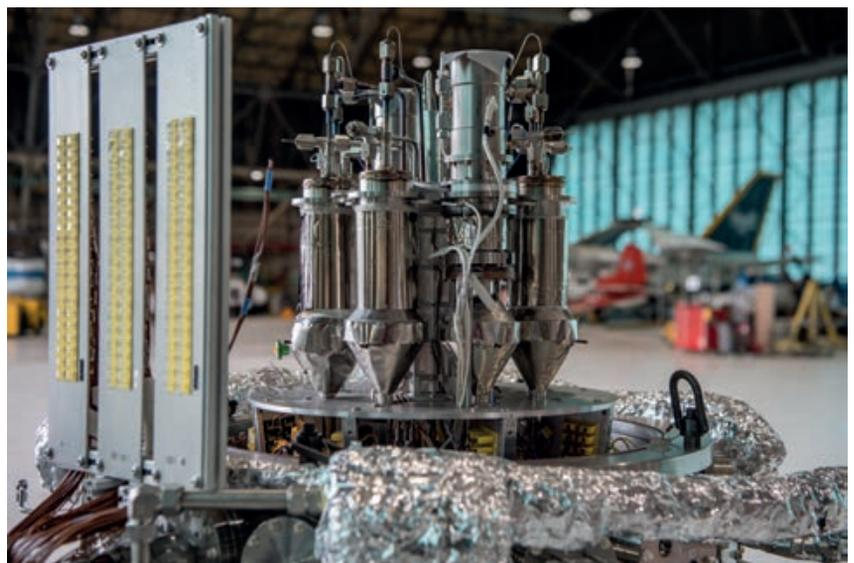
Prototipo de reactor nuclear Kilopower de 1 kW para uso en superficies espaciales y planetarias.
