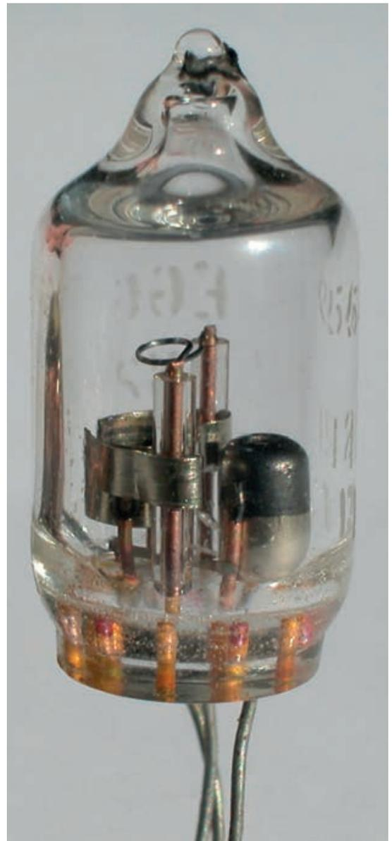
Imagen de un detonador krytron iniciador de las lentes de explosivo químico de las bombas atómicas. (Imagen: Wikipedia)
