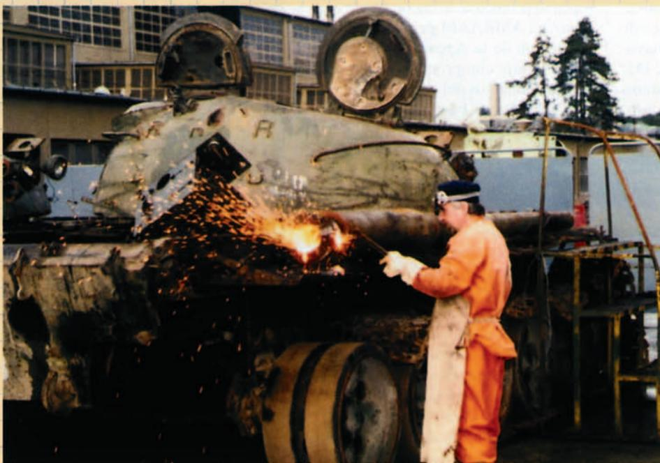
*Procedimiento de destrucción por seccionamiento. Hungría, Diciembre de 1993.*
