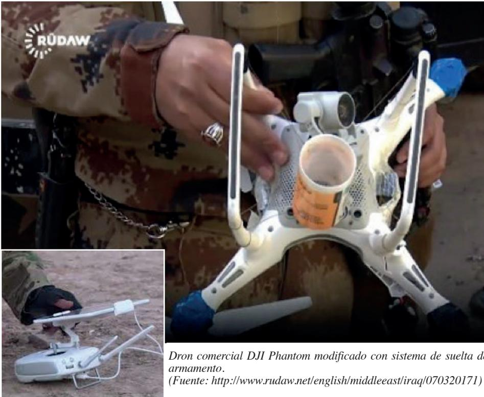
*Dron comercial DJI Phantom modificado con sistema de suelta de armamento.*
