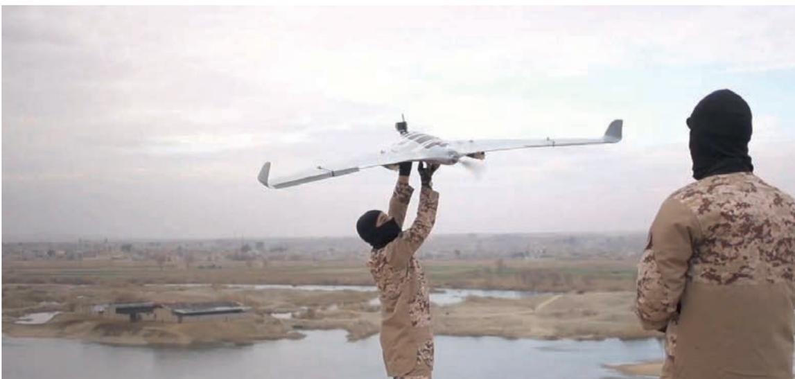
*Operadores de dron comercial Skywalker X8 modificado con dos proyectiles de 40 mm en estaciones subalares*
