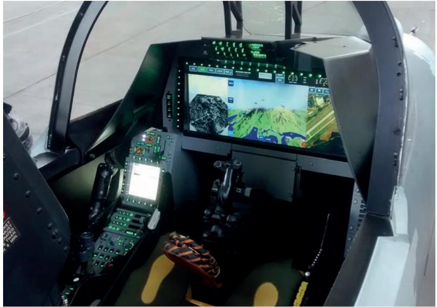
Cockpit digital con pantalla táctil del JAS-39E/F. (Imágenes de Saab. Delta de [foromilitar.com.ar](http://foromilitar.com.ar)).
