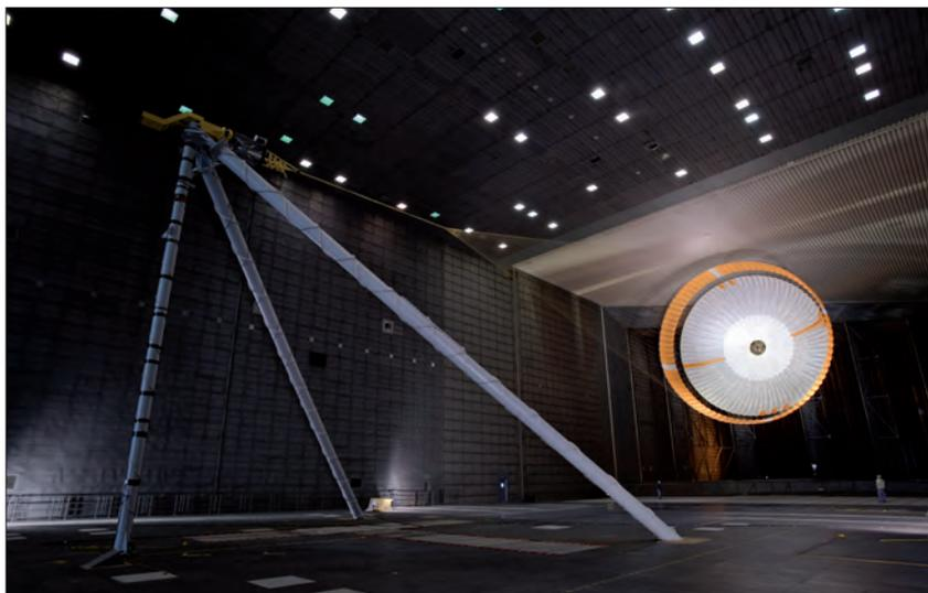
*Ensayo del paracaídas de frenado.*
