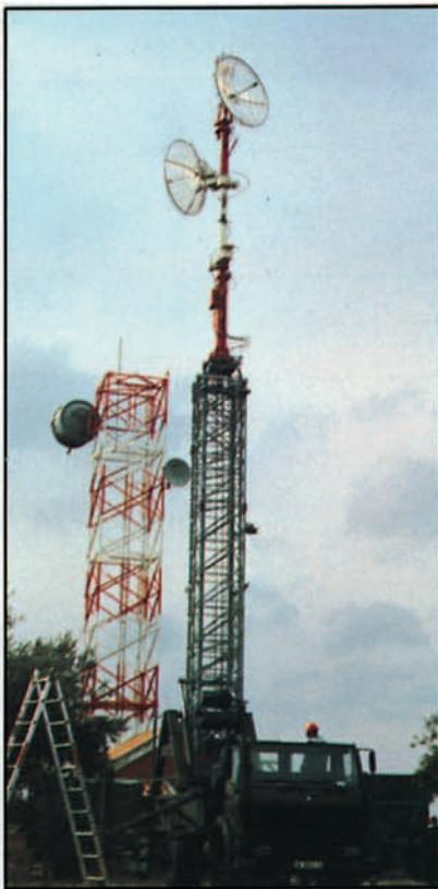
La utilización de medios de restauración de red es esencial para mantener la supervivencia de la misma. En la foto, estación móvil para sustituir una estación fija de la RMWEA.
