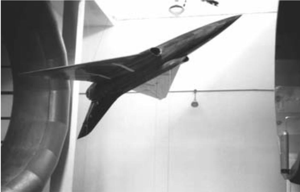
*Maqueta del HA-300 ensayada en el túnel aerodinámico del INTA (14 de junio de 1954). La configuración ensayada entonces respondía a la de un caza de superioridad aérea e interceptación equipado con un SNECMA ATAR 101E de 3.500 kg de empuje; la envergadura era 7,4 m, la superficie alar 24,62 m<sup>2</sup> y la longitud 13,11 m. El peso máximo de despegue calculado era de 5.000 kg y la velocidad máxima estimada era de 1.400 km/h.*
